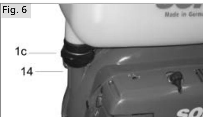
Den Brühebehälter ganz auf das Tragegestell schieben. Den Gummibalg zur Tankbelüftung (1c) komplett über den Wulst am Gebläsegehäusestutzen (14) stülpen.
