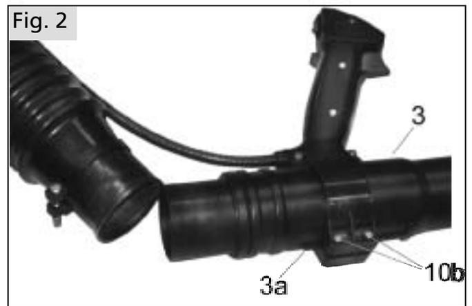
Die zwei unteren Schrauben (10b) am Bedienungshandgriff ganz lösen und den Bedienungshandgriff ganz lösen und den Bedienungshandgriff vom Blasrohr abnehmen. Den Bedienungshandgriff über das Sprührohr (3) schieben und die unteren zwei Schrauben wieder locker eindrehen. Achten Sie darauf, dass der Bedienungshandgriff noch an der vorgesehenen Führungsrippe (3a) des Sprührohres verschiebbar ist.
