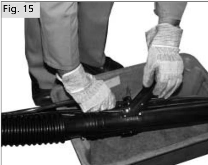
Ziehen Sie über dem Auffangbehälter den Zulaufschlauch vom Abstellhahn.
