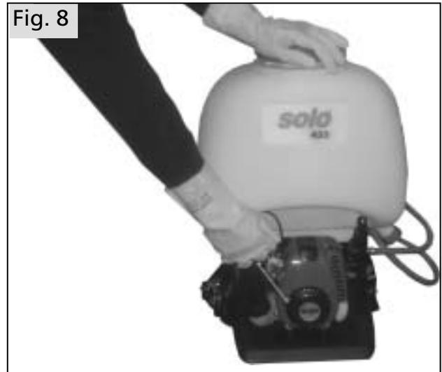
Posare lo spruzzatore ad alta pressione a motore sul terreno, avendo cura di posizionare l'attrezzo in modo stabile e sicuro. Fare attenzione che l'impugnatura del tubo spruzzatore non sia bloccata su servizio continuo. All'avviamento la valvola manuale deve essere chiusa.
