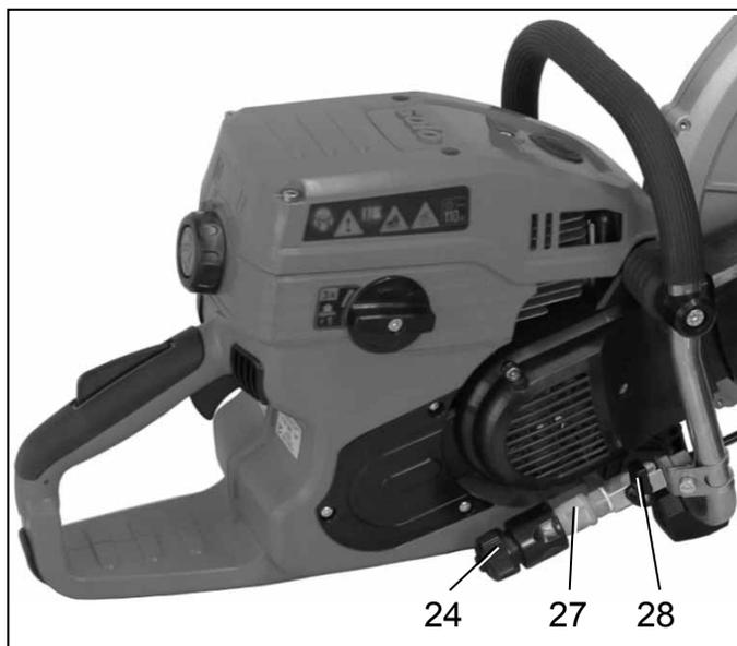
При резке минеральных веществ возникает очень много тонкодисперсной пыли. Мы рекомендуем использовать подачу воды при использовании для мокрой резки соответствующих отрезных дисков для минеральных веществ. При резке с подачей воды пыль связывается, визуальный контроль улучшается и срок эксплуатации отрезных дисков увеличивается благодаря охлаждающему действию воды.
