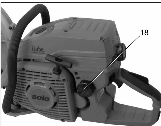
Les modèles 880-12 et 880-14 sont équipés d'un réservoir d'essence (18).
