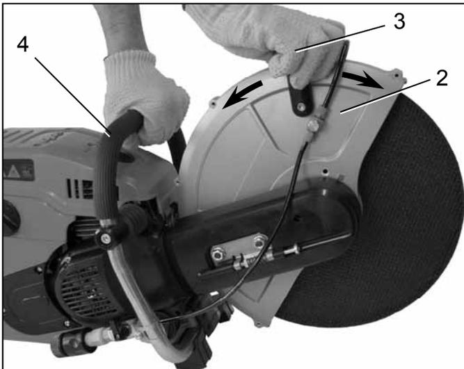
Le capot de protection (2) peut être pivoté en avant et/ou en l'arrière dans une certaine mesure.
