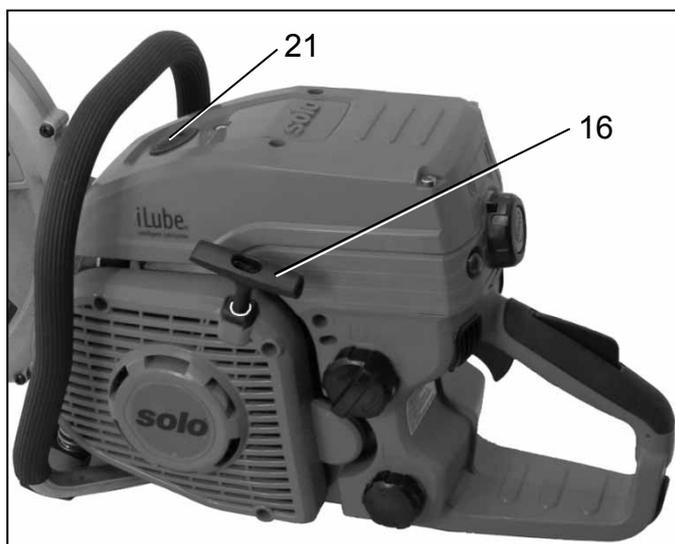
En actionnant la valve de décompression (21), une compression plus faible est obtenue dans la chambre de combustion du moteur. Ce qui signifie que le moteur oppose une force de résistance plus faible lors du démarrage ce qui facilite sensiblement le démarrage.
