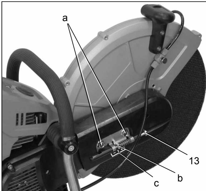
En principe, la tension de la courroie cannelée doit être ajustée correctement au démarrage de l'appareil à moteur. La tension doit absolument être vérifiée et ajustée lors de la première mise en service, après une remise en service après une période de non utilisation prolongée, après l'échange de la courroie cannelée ou après d'autres travaux de montage et la tension de la courroie cannelée doit éventuellement être corrigée.
