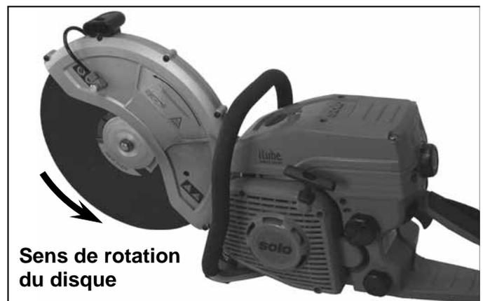
Le sens de rotation du disque est toujours celui indiqué ci-dessus par la flèche – indépendamment du fait de savoir si le dispositif de séparation est installé dans la position extérieure ou de moyenne.
