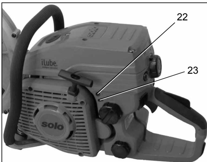
Avec un réglage correct du ralenti, le moteur devrait tourner sans à coups au ralenti, sans que le disque ne soit entraîné.
