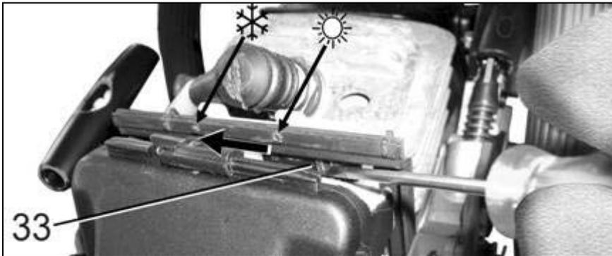
Para evitar con temperaturas externas bajas (inferiores a 5°C) congelaciones en el carburador, puede ser precalentado el aire de aspiración a través de un regulador (33) para el funcionamiento en invierno.
