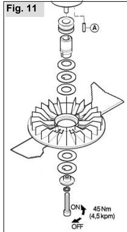
Beim Wechseln des Schneidwerkzeugs dürfen nur Original-Ersatzteile verwendet werden. Die Kennzeichnung des Messers muss mit der in der Ersatzteilliste angegebenen Bestell-Nummer übereinstimmen.
