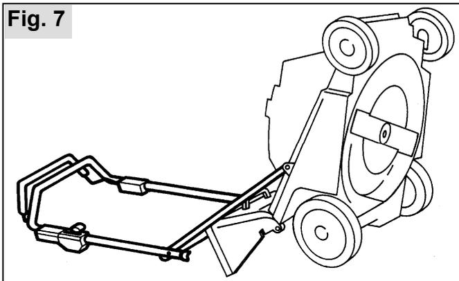
Nach Lockern der Spannhebelschrauben (8) kann der Mäher vorsichtig auf den Hinterrädern aufgestellt und über die Holm-Unterteile abgestützt werden. Dabei muss vorher der Zündkerzenstecker abgezogen werden und der Kraftstofftank möglichst leer sein um ein Auslaufen von Kraftstoff aus der Tankdeckellüftung auszuschließen. Evtl. aus dem Vergaser auslaufendes Benzin kann mit einem Lappen aufgefangen werden.
