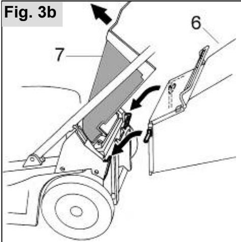
Zum Anbau der Grasfangvorrichtung Auswurfschutzklappe (7) mit einer Hand hochheben, mit der anderen Hand Grasfangvorrichtung (6) am Tragegriff halten und von schräg oben am Mähergehäuse einhängen.
