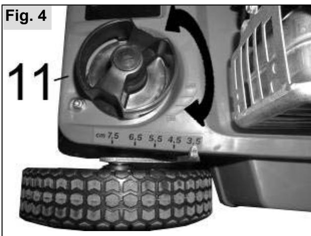
Ihr Mäher besitzt eine stufenlose Schnitthöhenverstellung von ca. 30 -80 mm. Die Höhenverstellung erfolgt für alle Räder über die Zentralverstellung (11). Drehen nach rechts verringert, drehen nach links vergrößert die Schnitthöhe. Diese lässt sich an der Markierung ablesen.
