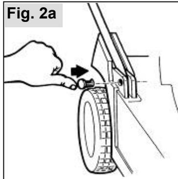
Aus Transportgründen sind die Lagerbolzen für das Holm-Unterteil nicht eingesetzt.
