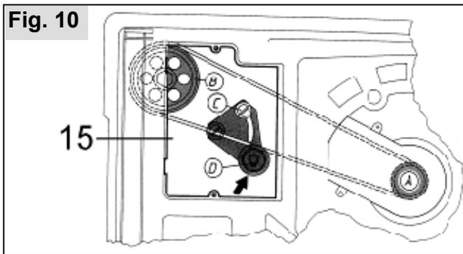
Deckel für Batterie-Getrieberaum (15) nach Lösen der beiden Schrauben abnehmen. Befestigungsschraube (C) des Spannhebels lösen. Keilriemen durch Verschieben des Spannhebels (in Pfeilrichtung) spannen.
