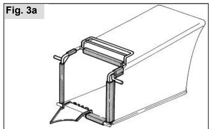
Setzen Sie die Kunststoffschaufel am Rahmen-Unterteil auf und drücken Sie sie nach unten, bis die Schaufel am Rahmenteil einrastet.
