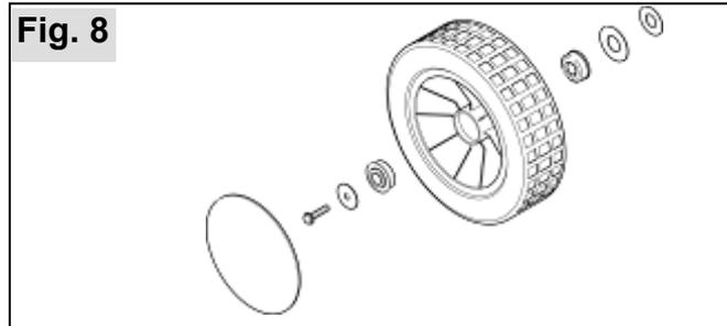
Radachsen und Radnaben sollten von Zeit zu Zeit (mindestens 1 x jährlich) leicht eingefettet werden. Dazu Radkappe abnehmen, Schraube lösen und Rad abziehen. Achten Sie beim Zerlegen auf die Reihenfolge der Einbauteile. Wir empfehlen das SOLO Lagerfett Best.-Nr. 00 83 175.
