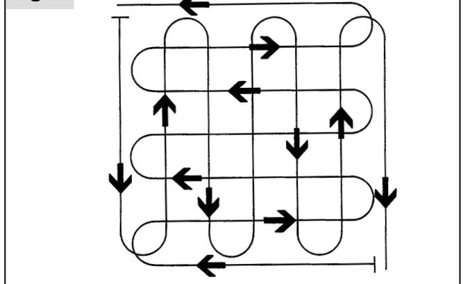
Bei langem Gras daher zuerst in der einen Richtung mit hoher Schnitteinstellung und deutlicher Überlappung der Mähbahnen mähen, dann quer dazu mit tieferer bzw. normaler Schnitthöheinstellung (Fig. 6).
