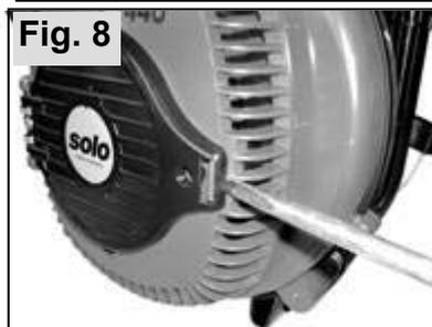
Appuyer avec un tournevis dans l'ouverture latérale du couvercle de la soufflerie pour déverrouiller le couvercle.
