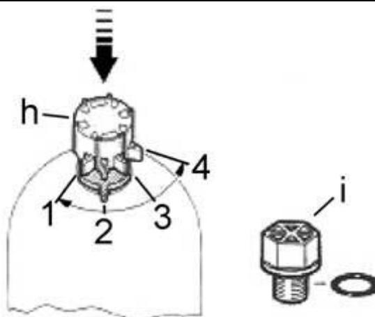
Para ajustar la cantidad de pulverización o bien el tamaño de las gotitas, regule la presión de pulverización mediante los escalones en un campo de aprox. 1 a 4 bares.
