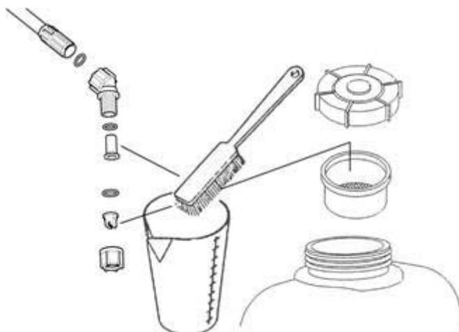
Limpie periódicamente la tolva del filtro de la abertura del depósito, el filtro y la boquilla de inyección con agua y un cepillo suave. Nunca intente limpiar la boquilla inyectora soplando con la boca.
