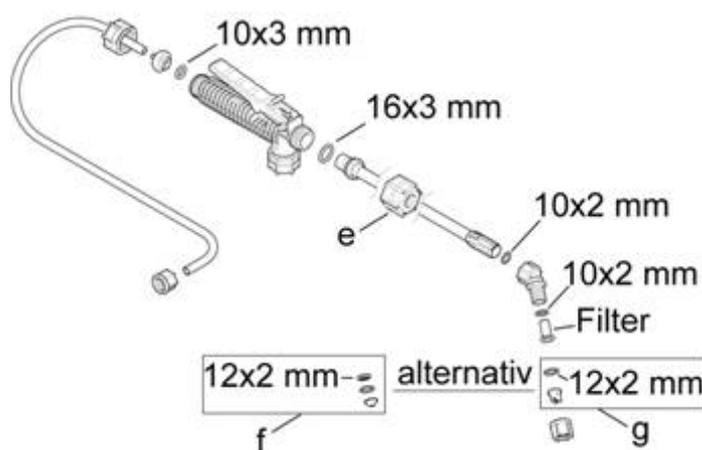
El tubo de pulverización es fijado por medio de la conexión de cuña cortante atornillando la tuerca de unión (e) en la válvula de mano.
