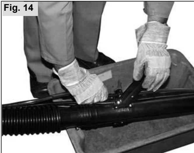
Posizionate il tubo sopra il contenitore di raccolta, in modo che il contenuto del serbatoio possa scorrervi direttamente.
