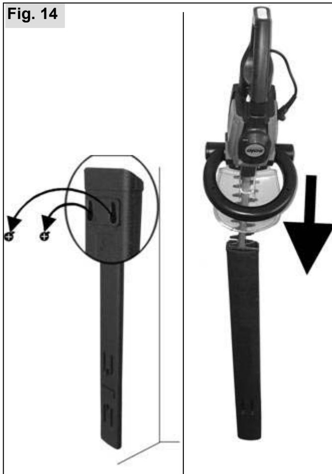
La protezione della lama (11) può essere appesa ad una parete per un sicuro stoccaggio della cesoia per siepi.
