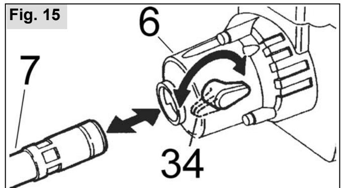
Staccare il tubo pieghevole (7) dalla flangia motore (6) dopo avere mandato in avanti la levetta di blocco (34).
