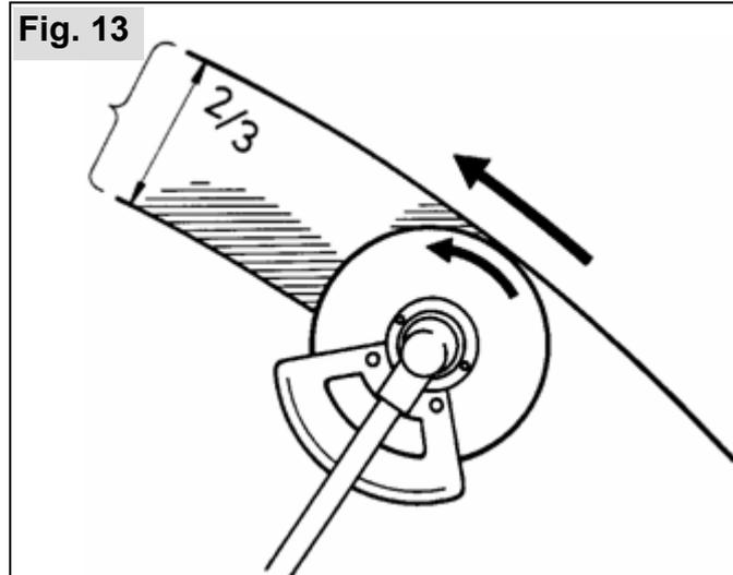
Affrontare il materiale da falciare con il motore del decespugliatore al minimo e poi dare gas. Non fare girare a vuoto troppo a lungo il motore.
