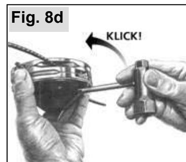
Inserire il coperchio della testina da taglio, girare in direzione della freccia e stringere con la chiave combinata come indicato dalla figura fino a quando non è completamente inserita.
