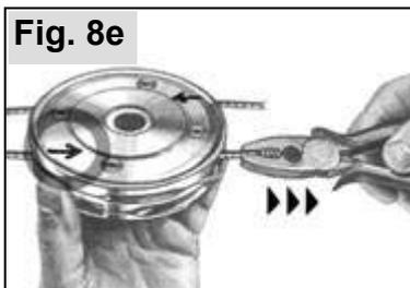
Quando si desidera sostituire un filo, tirarlo nuovamente in direzione della freccia estraendolo dal corpo della testina (se necessario utilizzare un paio di pinze).
