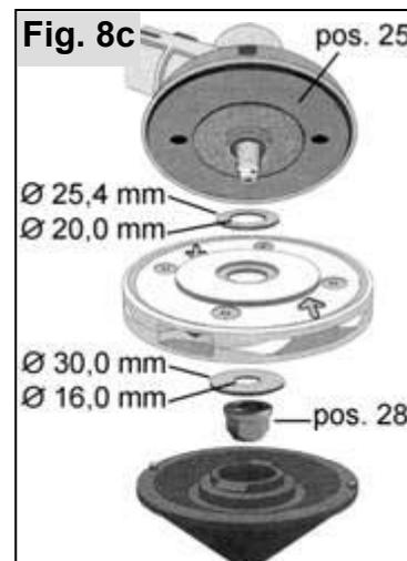
Nel corredo fornito con la testina da taglio vengono forniti vari spessori. Per il montaggio su questo tipo di decespugliatore è necessario fare attenzione ed utilizzare esattamente gli spessori corrispondenti alle dimensioni riportate nella figura. (Diametro esterno, diametro interno).
