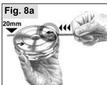
Introduisez les fils de coupe dans le corps de la tête de coupe suivant les flèches sur le corps pour que le fil sorte d'environ 20 mm de l'ouverture opposée.
