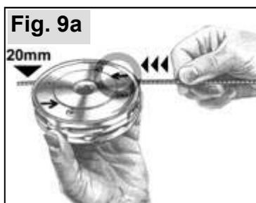
Introducir los hilos de corte en el cuerpo central del cabezal de corte, según las flechas del cuerpo central, de modo que de la abertura del lado opuesto sobresalgan aprox. 20 mm del hilo de corte.
