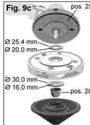
El volumen de suministro del cabezal de corte contiene diferentes arandelas. Para el montaje a este tipo de desbrozadora, se deben utilizar exactamente las arandelas según las medidas indicadas en la ilustración. (Diámetro exterior, diámetro interior).
