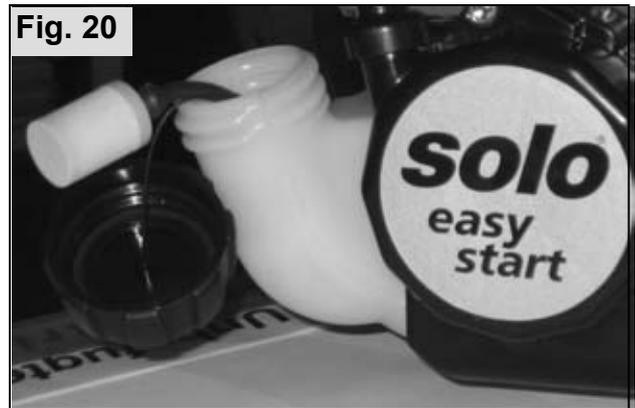
Der Kraftstofffilter lässt sich vom Fachmann über eine Drahtschlinge vorsichtig zur Öffnung des Kraftstofftanks ziehen. Es ist darauf zu achten, dass die Verdickung des Kraftstoffschlauches an der Tankwand nicht in den Tank gezogen wird.
