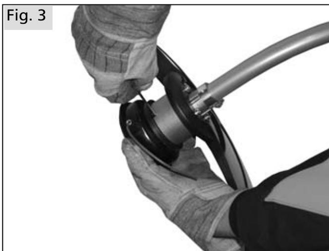
Bloquez l'arbre d'entraînement à l'aide de la goupille de fixation (clef allen). Vissez la tête à fil dans le sens des aiguilles d'une montre sur l'arbre d'entraînement.
