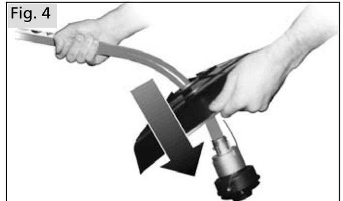
Amenez la protection par le haut dans la bonne position via le tube de transmission. En position de travail correcte, la protection doit être orientée vers l'utilisateur.
