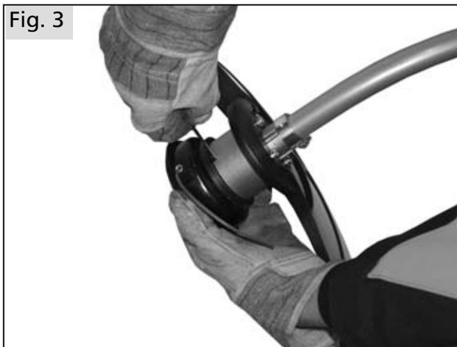
Bloquee el engranaje con la espiga (llave de tipo hexagonal). Acople el cabezal de hilo al engranaje girándolo en el sentido de las agujas del reloj.
