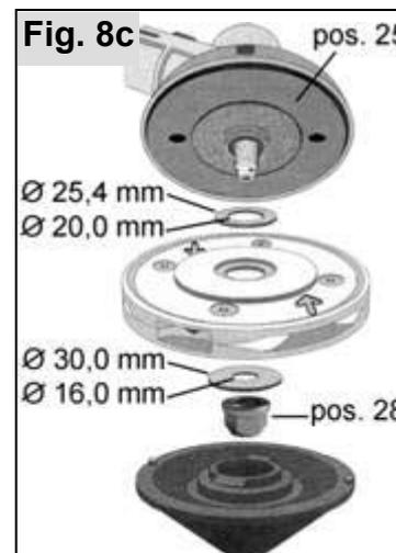
Nel corredo fornito con la testina da taglio vengono forniti vari spessori. Per il montaggio su questo tipo di decespugliatore è necessario fare attenzione ed utilizzare esattamente gli spessori corrispondenti alle dimensioni riportate nella figura. (Diametro esterno, diametro interno).
