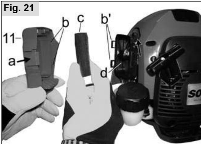
Prima di aprire il filtro dell'aria chiudere la farfalla dello starter
