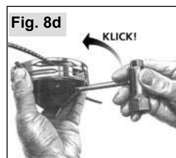
Inserire il coperchio della testina da taglio, girare in direzione della freccia e stringere con la chiave combinata come indicato dalla figura fino a quando non è completamente inserita.
