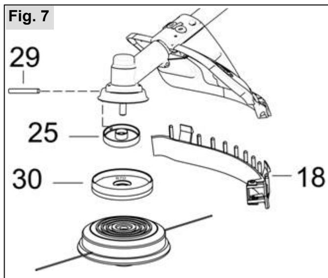
Per il montaggio della testa a fili di nylon non sono necessari i seguenti pezzi come indicato alla figura Fig. 5:
