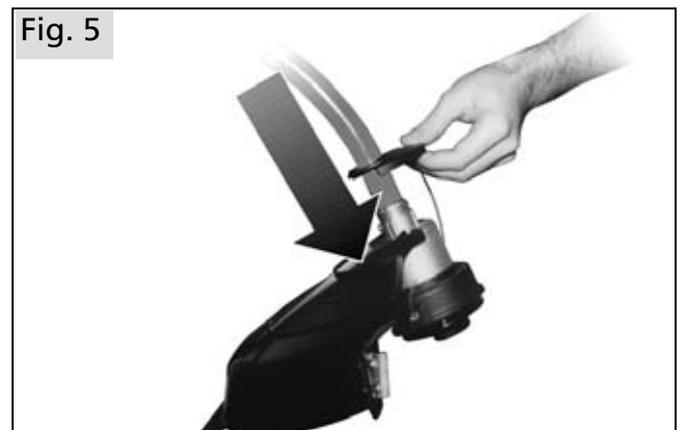
Amenez également la pièce de fixation dans la bonne position via le tube de transmission de façon à ce que la partie ouverte du cercle soit dirigée vers l'utilisateur.
