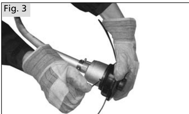
Bloquez l'arbre d'entraînement à l'aide de la goupille de fixation (clef allen). Vissez la tête à fil dans le sens des aiguilles d'une montre sur l'arbre d'entraînement.
