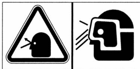
Gefährdung durch Gegenstandfortschleudern. Augenschutz unbedingt tragen!
