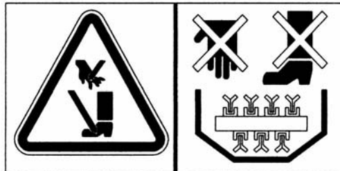
Gefährdung durch Berührung der oberen und unteren Gliedmaßen. Hände und Füße nicht in das laufende Schneidewerkzeug stecken
